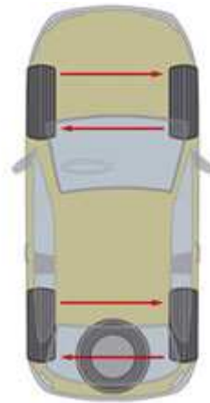
Rotación de Neumáticos con medidas diferentes, en la Delantera y en la Trasera, de construcción radial
